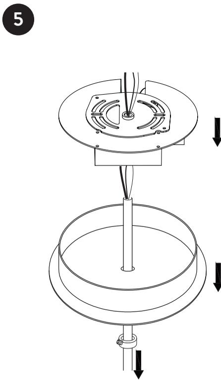
! NEVER HOLD THE FIXTURE ON THE SIDE. IT WILL AUTOMATICALLY BREAK THE STEM
